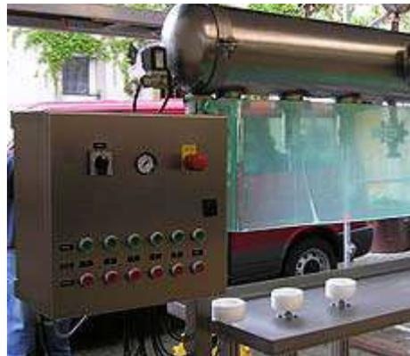
Автоматическая установка для розлива в бутылку с двумя, четырьмя или шестью наполнительными головками автоматически разливает пиво в бутылки и бочки.
